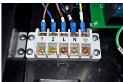
Sur les pompes **Model Name**, se connecter sur le bornier L(Phase, rouge), N(Neutre,bleu) et Terre (jaune et vert).
